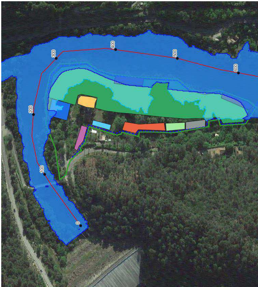
Figure 10 : Emprise de la crue centennale avec le stock de matériaux (couleur bleu foncé) et sans (emprise en bleu clair)
